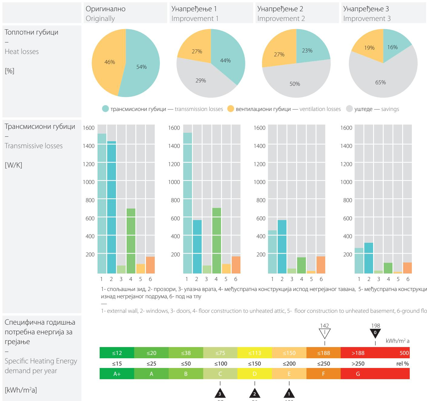
**Унапређење термичког омотача и система грејања – енергетски биланс — Thermal envelope and heating systems improvement – energy balance**
