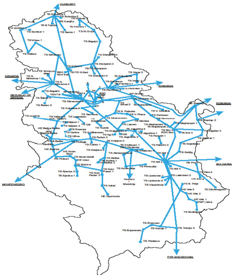
Илустрација 3. Мрежа оптичких каблова изграђена на мрежи далековода
